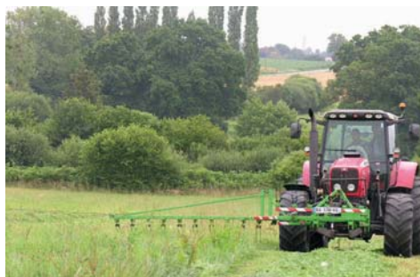
Tracteur équipé d'une barre d'effarouchement. Avançant à une faible allure, il laisse toutes ses chances à la faune sauvage.
